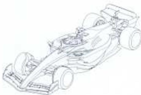
EL DISEÑO ESTÁ RELACIONADO A UN AUTOMÓVIL/AUTOMÓVIL DE JUGUETES QUE COMPRENDE: "- UNA PARTE DELANTERA CON UNA ALERÓN DELANTERO, SUSPENSIONES DELANTERAS Y RUEDAS DELANTERAS;"- UNA PARTE INTERMEDIA CON UN COMPARTIMIENTO DE CONDUCTOR; Y "- UNA PARTE TRASERA CON UNA ALERÓN TRASERO, SUSPENSIONES TRASERAS Y RUEDAS TRASERAS. "
