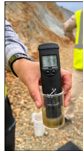
Fotografía 34. Resultado de pH 2.4 posterior a la prueba de generación de DAR.
