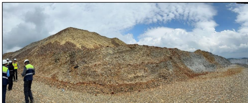
Fotografía 31. Vista frontal de las pilas de acopio de mineral de baja ley.
