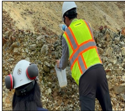
Fotografía 33. Personal de MPSA realizando prueba rápida de generación de DAR.
