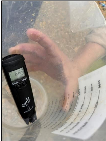
Fotografía 32. Prueba rápida de generación de DAR (pH 6.8 del agua antes de prueba)
