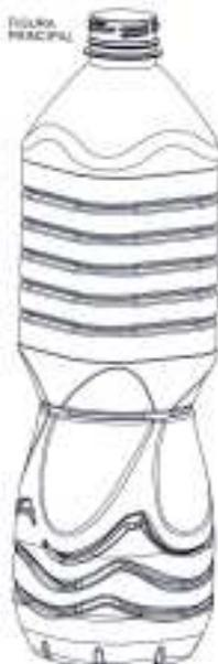
EL MODELO INDUSTRIAL CONSISTE EN UNA FORMA DE BOTELLA ÚNICA CON LA PARTE CENTRAL HUECA QUE MUESTRA UNA FORMA ESPECÍFICA Y LÍNEAS GEOMÉTRICAS GRABADAS. LA FORMA DE LA BOTELLA ES CUADRADA EN LA PARTE SUPERIOR CON CUATRO SECCIONES A CADA LADO Y CINCO PARTES DIFERENTES DE ARRIBA ABAJO, TODAS ELLAS ENMARCAN SUS CARACTERÍSTICAS ESENCIALES.
