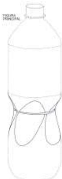
EL MODELO INDUSTRIAL CONSISTE EN UNA FORMA DE BOTELLA QUE DESTACA SU PARTE CENTRAL HUECA QUE MUESTRA UNA FORMA ESPECÍFICA DE LÍNEAS GEOMÉTRICAS. LA FORMA ESPECÍFICA DE LA PARTE CENTRAL DE LA BOTELLA CORRESPONDE A UN RECORTE CÓNICO CUYA ORIENTACIÓN SE INVIERTE A LA ALTURA DE UNA LÍNEA HORIZONTAL MEDIA. ESTA PARTE MUESTRA FORMAS SEMIOVOIDES EN RELIEVE LIGERAMENTE ORIENTADAS EN DIAGONAL. ESTAS FORMAS SEMIOVOIDES SE COMBINAN CON OTRAS MÁS PEQUEÑAS EN LA PARTE SUPERIOR Y MÁS GRANDES EN LA INFERIOR.
