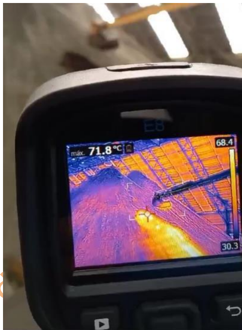
Figura No.30 Imagen termal de la temperatura interna de la pila de concentrado de cobre
