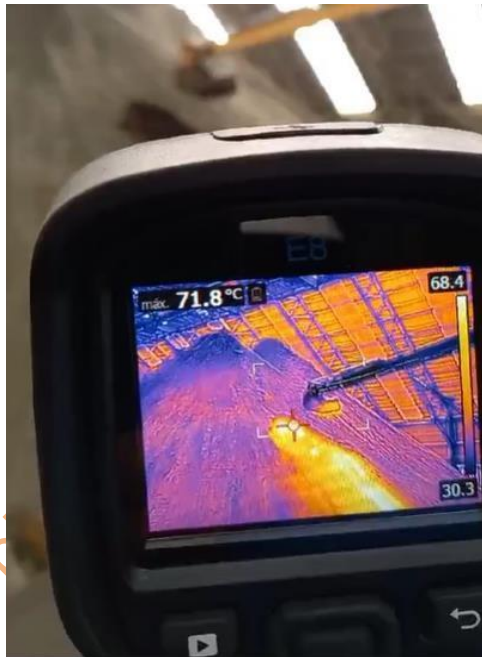
Figura No.27 Imagen termal de la temperatura interna de la pila de concentrado de cobre
