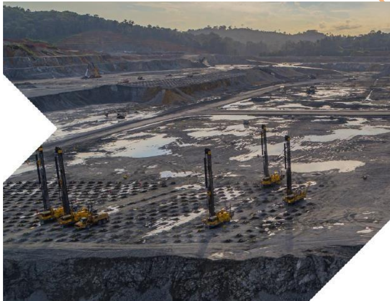
Figura No.7 Patrón de voladura
