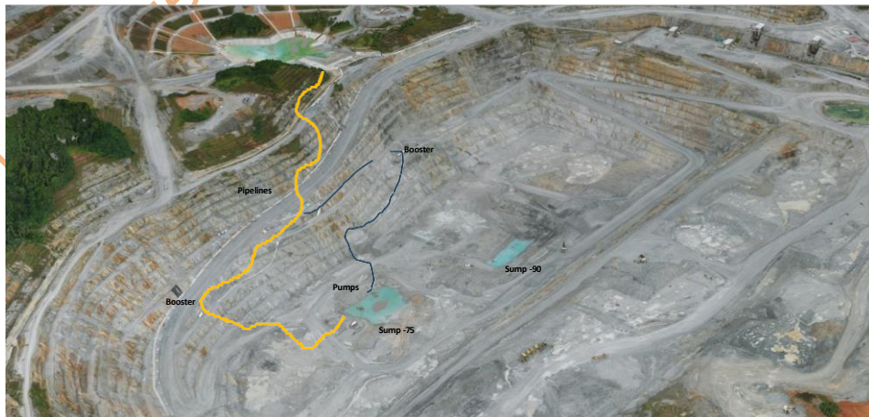
Figura No.6 sistema de desaguado de mina
