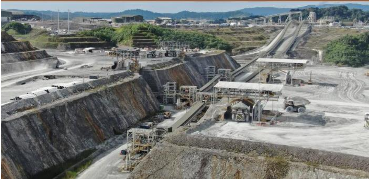
Figura No.10 Trituradoras dentro del tajo
