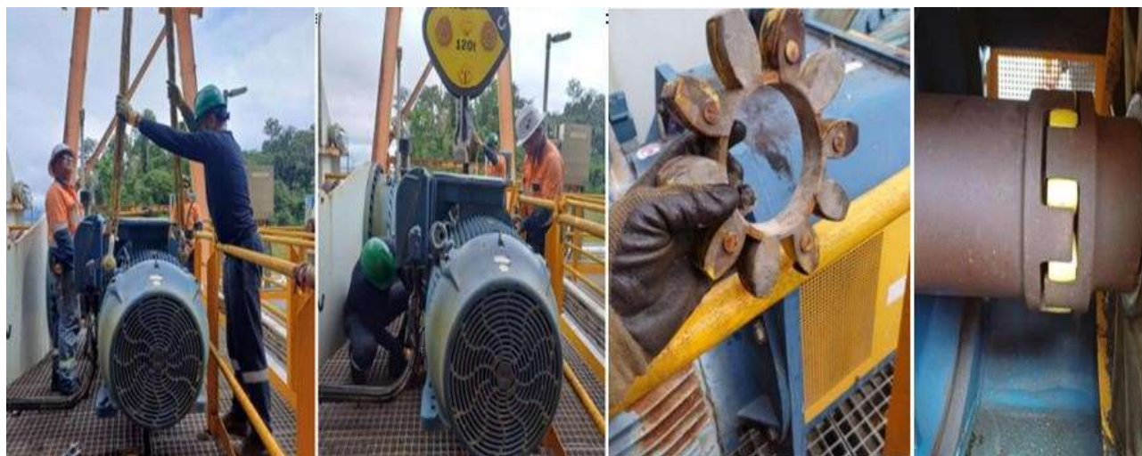
Ilustración 26 Reemplazo de elastómero en Acople de reductor 313-CV-9002
