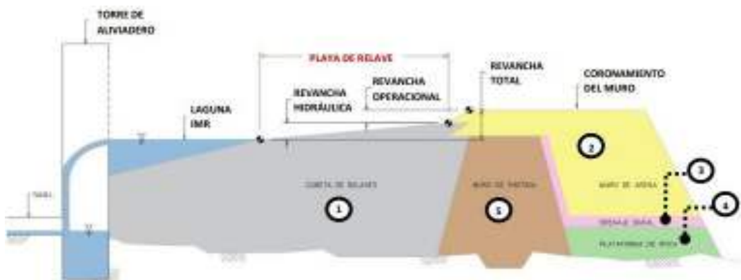
Figura 10 - Esquema de almacenamiento y niveles de agua de la IMR
