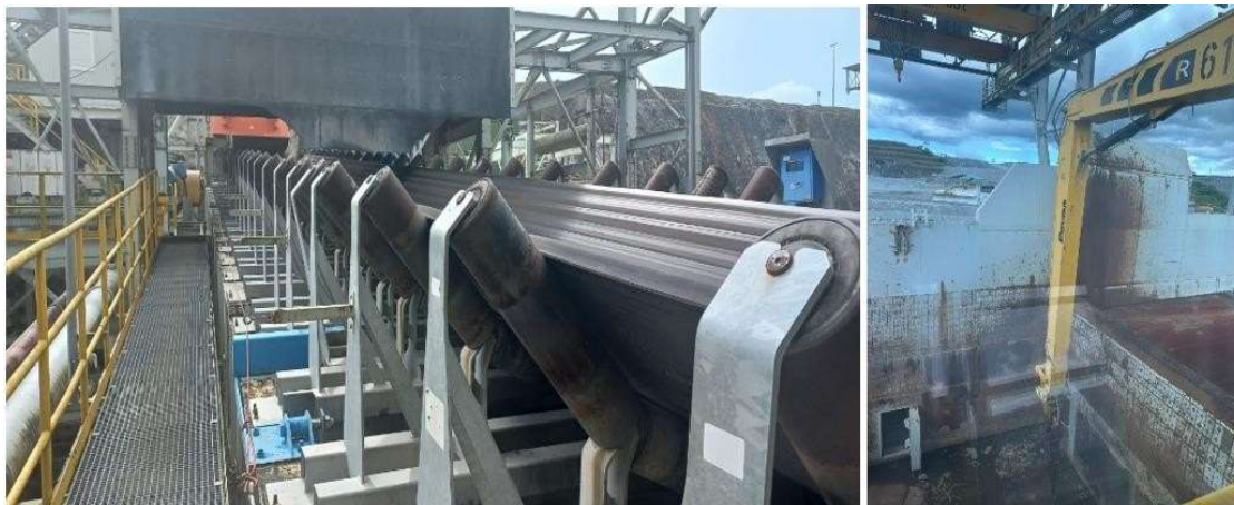
Ilustración 22 Prueba de funcionamiento de faja transportadora y romperocas
