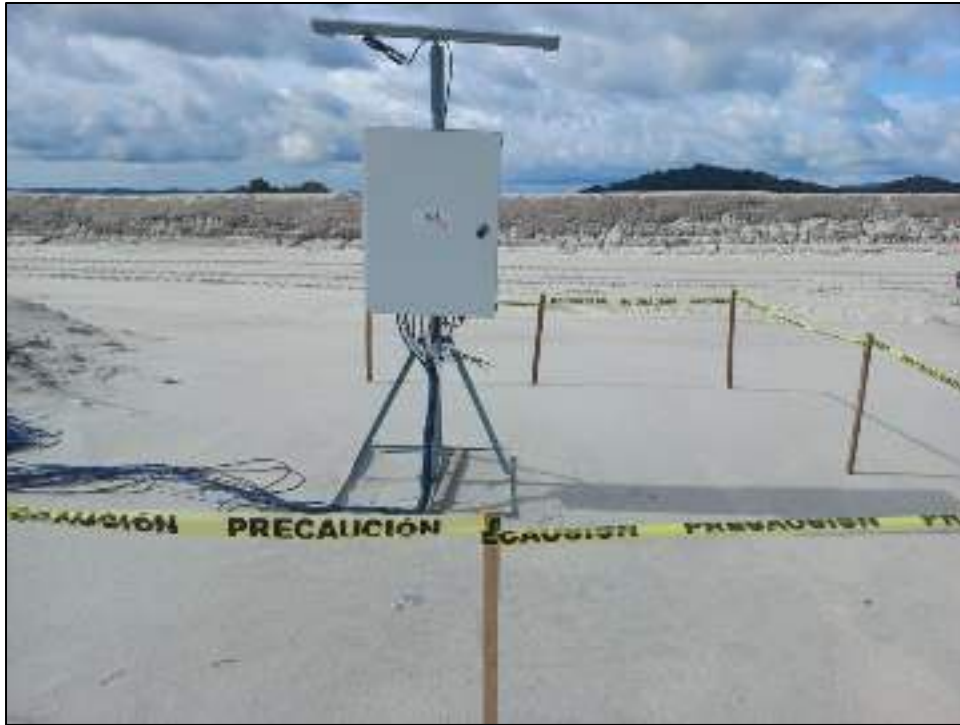
Figura 98 - Implementación de captación de datos por telemetría, Muro Norte-Sector 2
