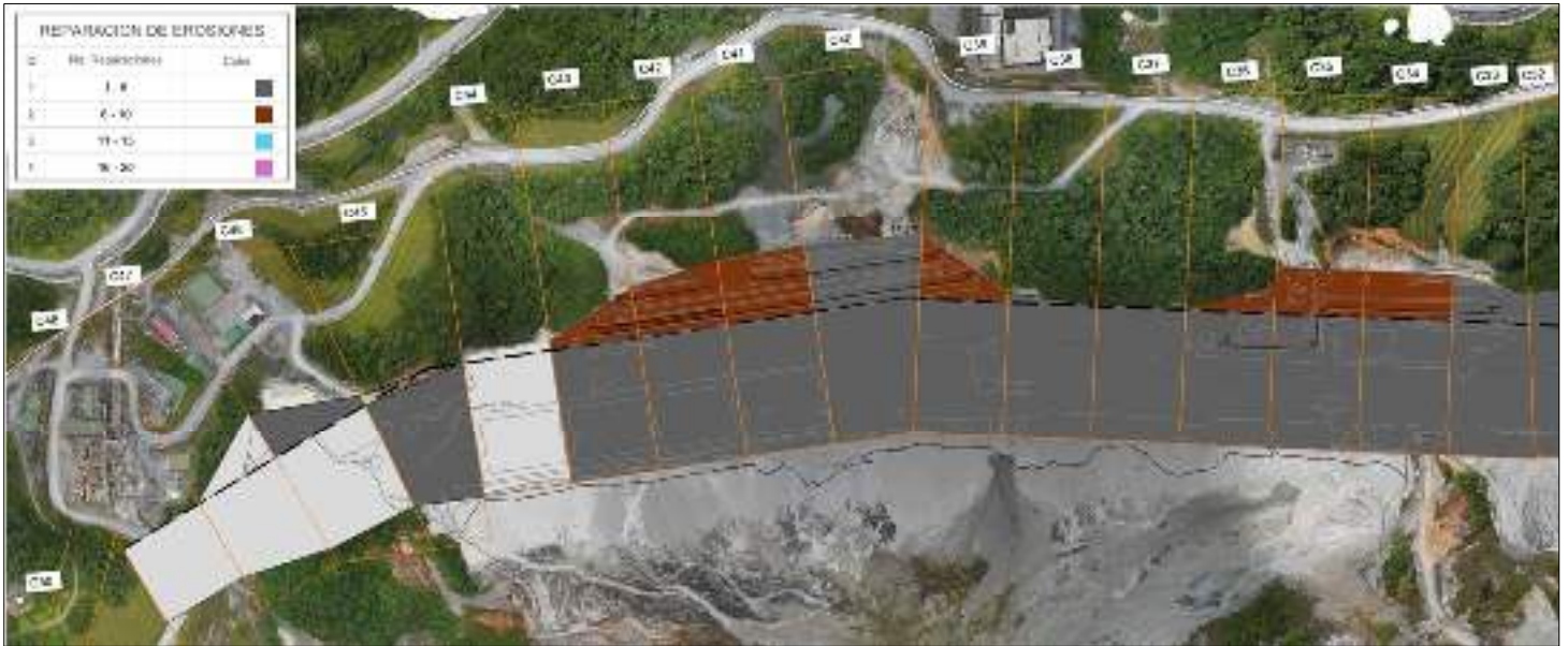
Figura 23 - Mapa de frecuencia de reparación de erosiones Muro Este (Celdas 45 a 33)
