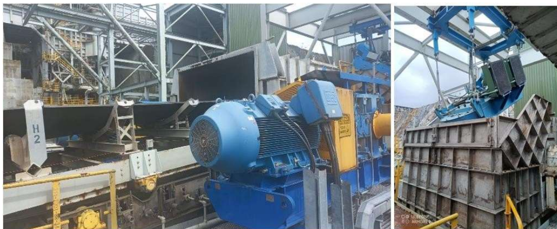
Ilustración 23 Prueba de motor de fajas transportadoras, Verificación de Magneto de la faja
