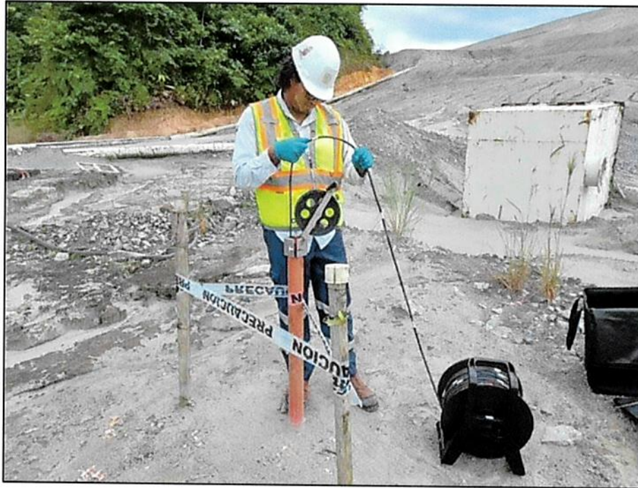
Figura 89 - Lectura de instrumentación geotécnica (inclinómetro)
