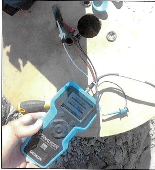
Figura 91 - Verificación del funcionamiento de los instrumentos reubicados en la trinchera
