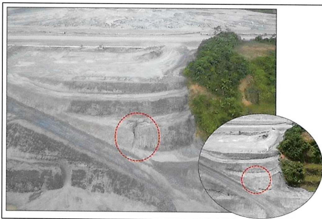
Figura 85 - Erosión Reparada en el Muro Este, Celda 20 Aguas Abajo
