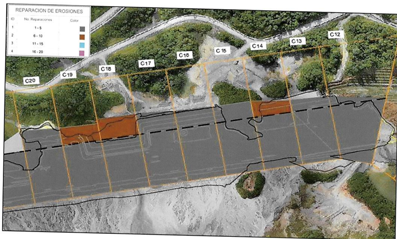
Figura 24 - Mapa de frecuencia de reparación de erosiones Muro Este (Celdas 20 a 12)
