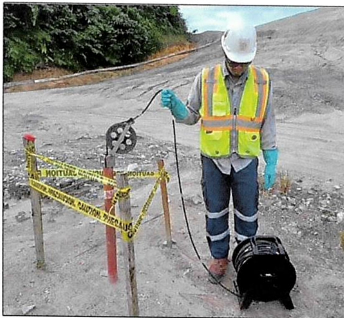
Figura 77 - Lectura de instrumentación geotécnica (Casagrande e inclinómetro)
