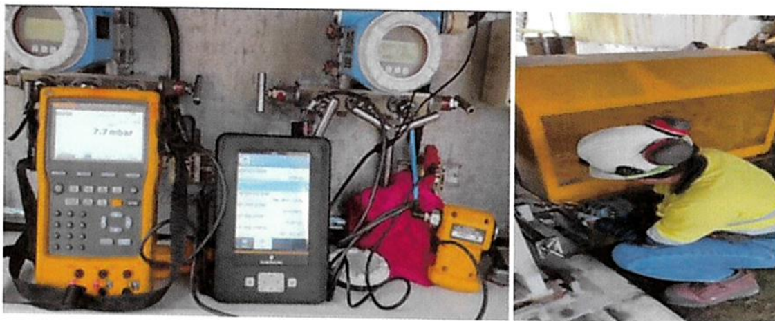
Pruebas a transmisores de presión
