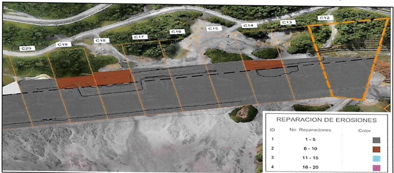
Figura 24 - Mapa de frecuencia de reparación de erosiones Muro Este (Celdas 20 a 12)
