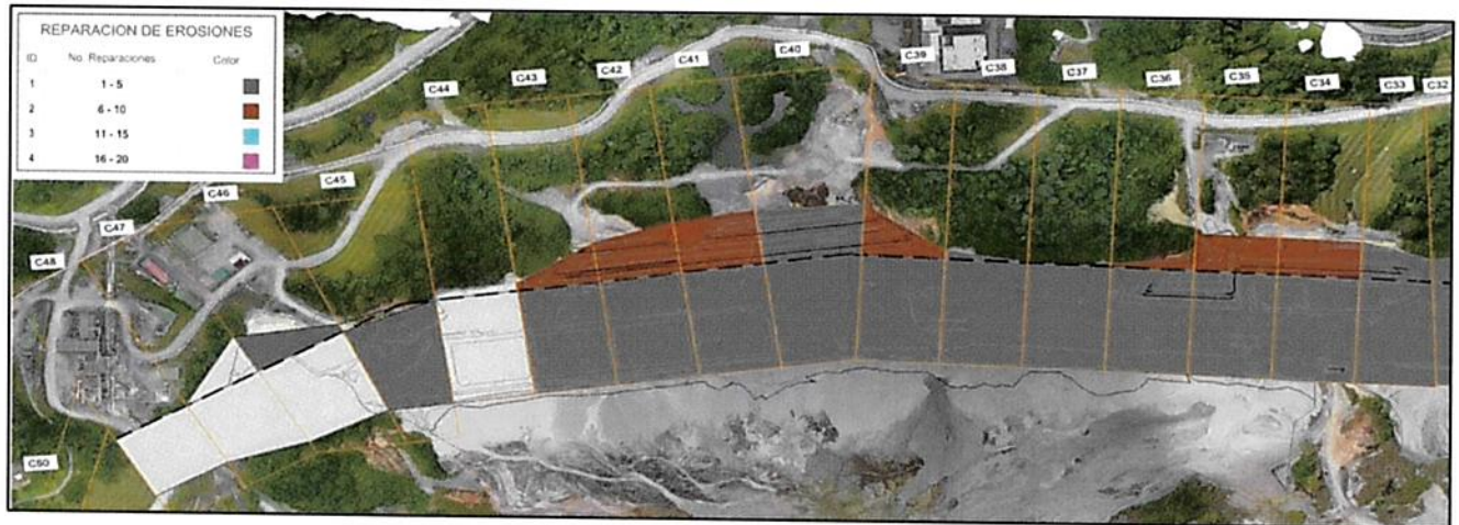
Figura 22 - Mapa de frecuencia de reparación de erosiones Muro Este (Celdas 48 a 33)
