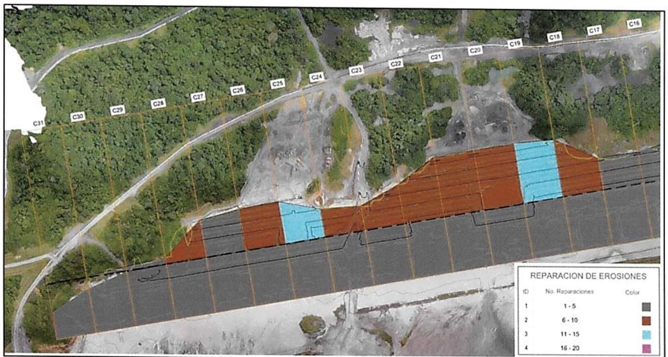
Figura 21 - Mapa de frecuencia de reparación de erosiones Muro Norte (Celdas 17 a 31)
