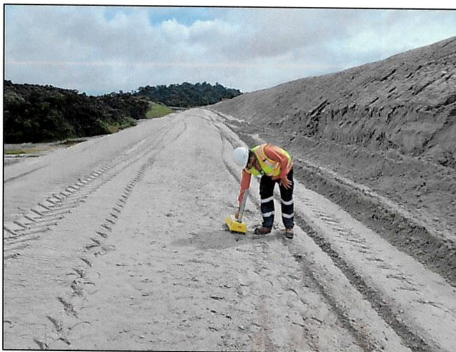
Figura 71 - Prueba de densidad en reparación de erosión Muro Norte, Celda 12
