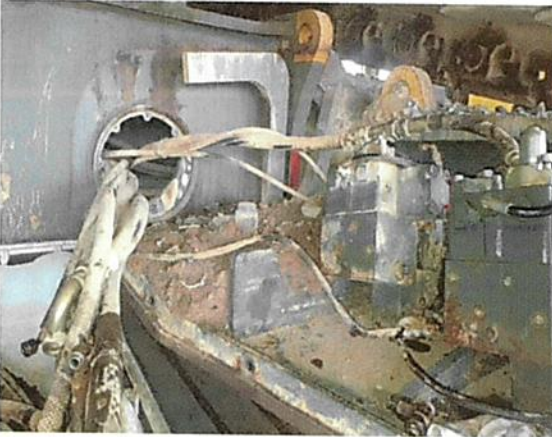
EXL004 / Limpieza y cambio de líneas traslación
