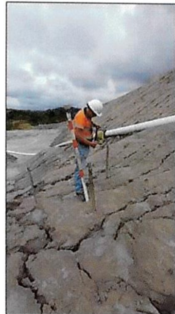
Figura 77 - Lectura de instrumentación geotécnica (Casagrande e inclinómetro)
