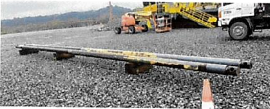
DRE203 Desmontaje de cilindros de Pulldown
