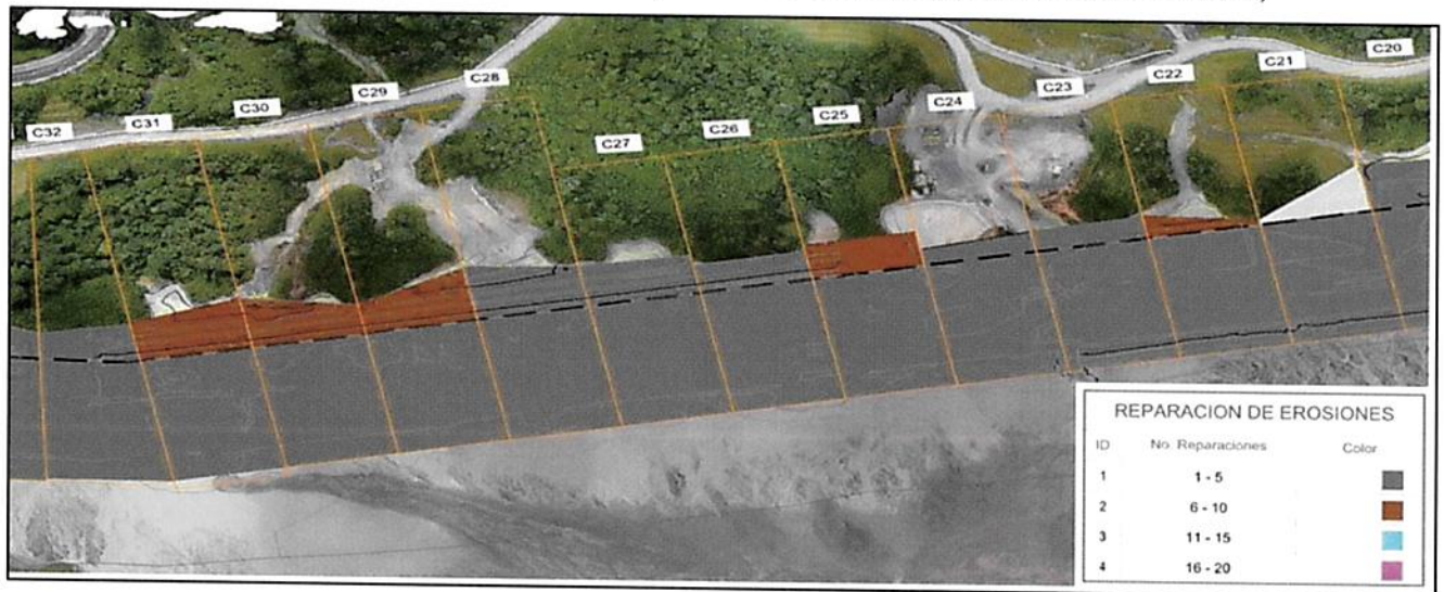
Figura 23 - Mapa de frecuencia de reparación de erosiones Muro Este (Celdas 32 a 21)
