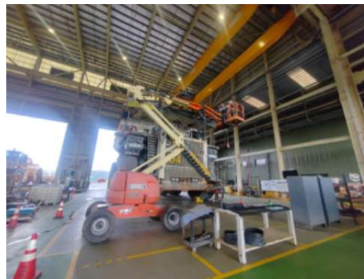
DTU004 y DTU007 – Inspección de Pantógrafo
