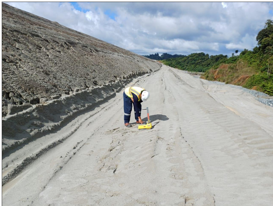
Figura 71 - Prueba de densidad en reparación de erosión Muro Norte, Celda 09
