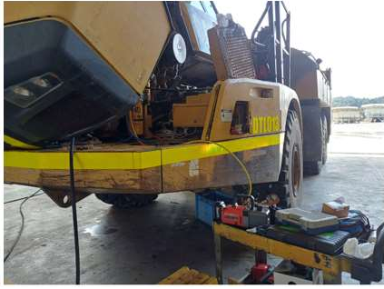
DTL013. Reparación Aire acondicionado
