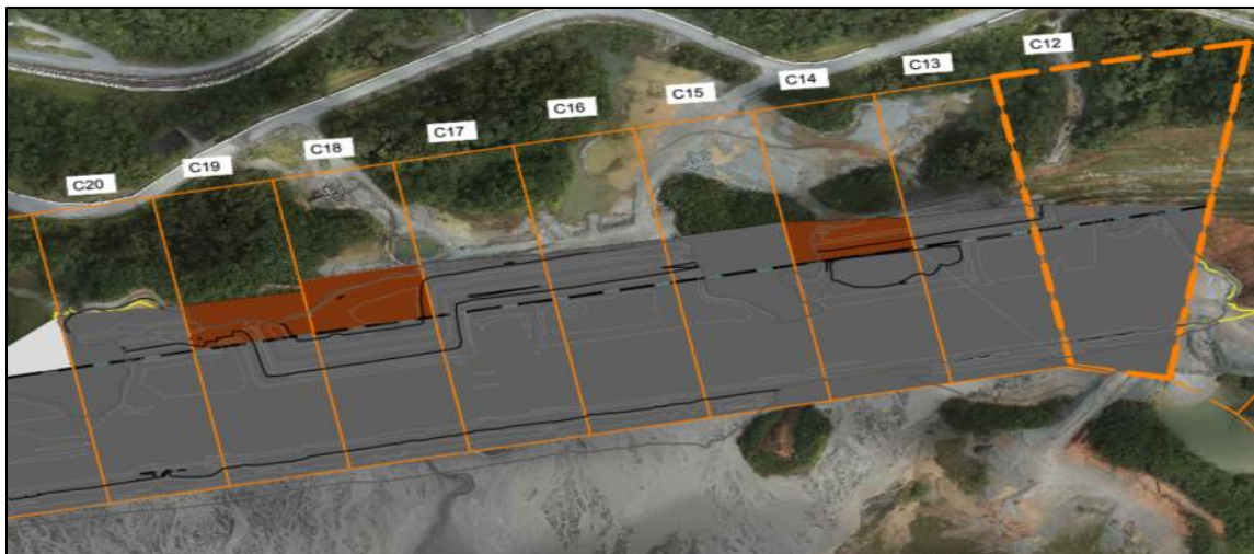
Figura 23 - Mapa de frecuencia de reparación de erosiones Muro Este (Celdas 20 a 12)
