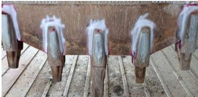
EXL107. Pruebas de NDT de bucket para entrega de equipo.
