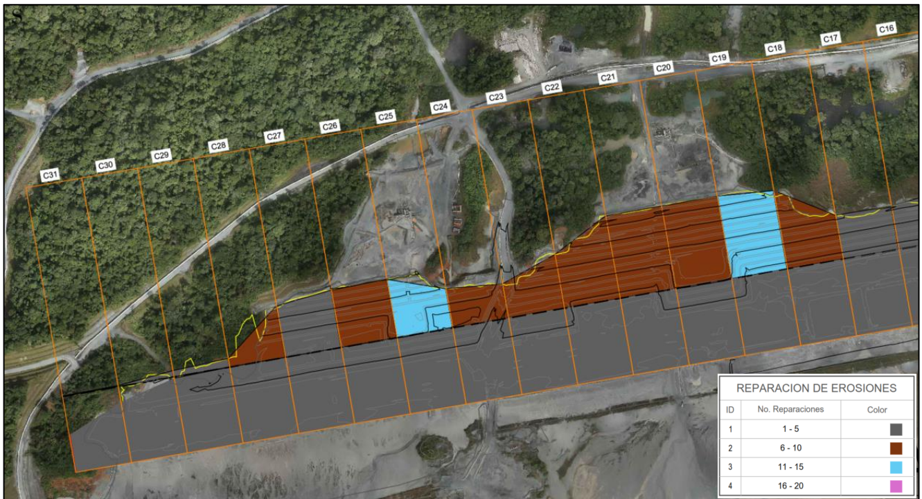
Figura 20 - Mapa de frecuencia de reparación de erosiones Muro Norte (Celdas 17 a 31)
