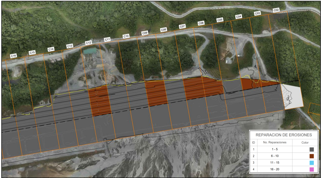
Figura 19 - Mapa de frecuencia de reparación de erosiones Muro Norte (Celdas 02 a 16)
