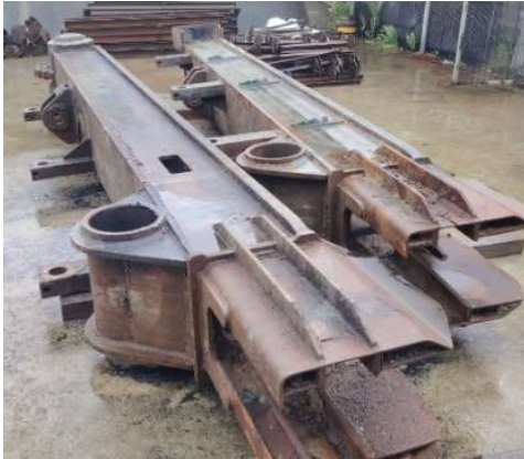
DRE108. Entrega de bastidores al área de sandblasting
