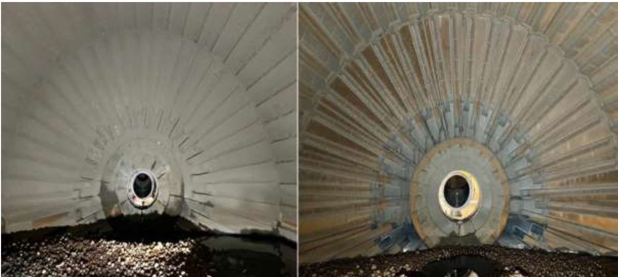
Ilustración 31 3D Scan de los molinos de bolas 5 y 6.
