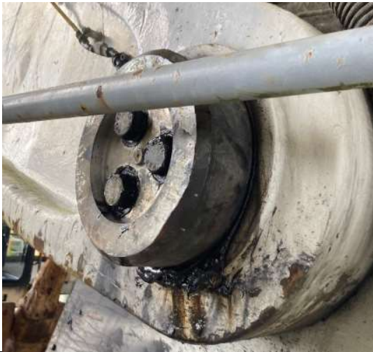
EXL106. Instalación de Pin Boom Stick
