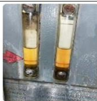
Foto N° 2 – Inspeccion y reparacion del sistema lubricacion RE1A
