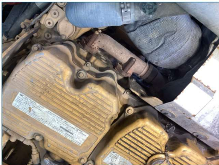
DTA155. Múltiple de escape con Fuga por tornillos rotos
