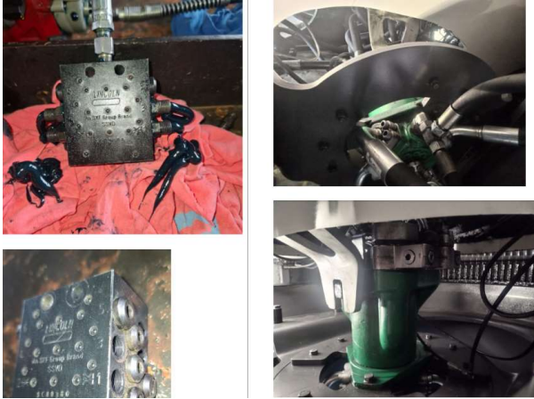
EXL107: Limpieza de viga central y evaluación del sistema de engrase
