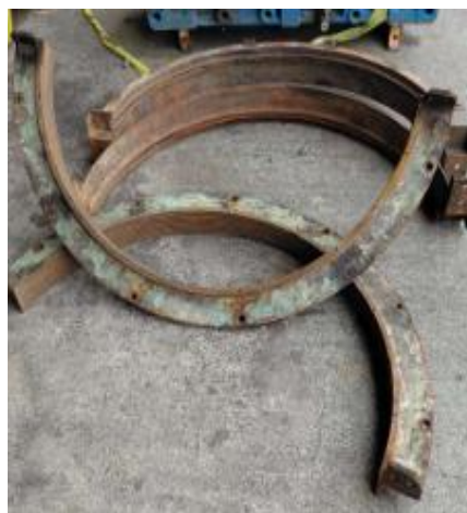
Cambio de sello inferior de la mesa del molino 2D
