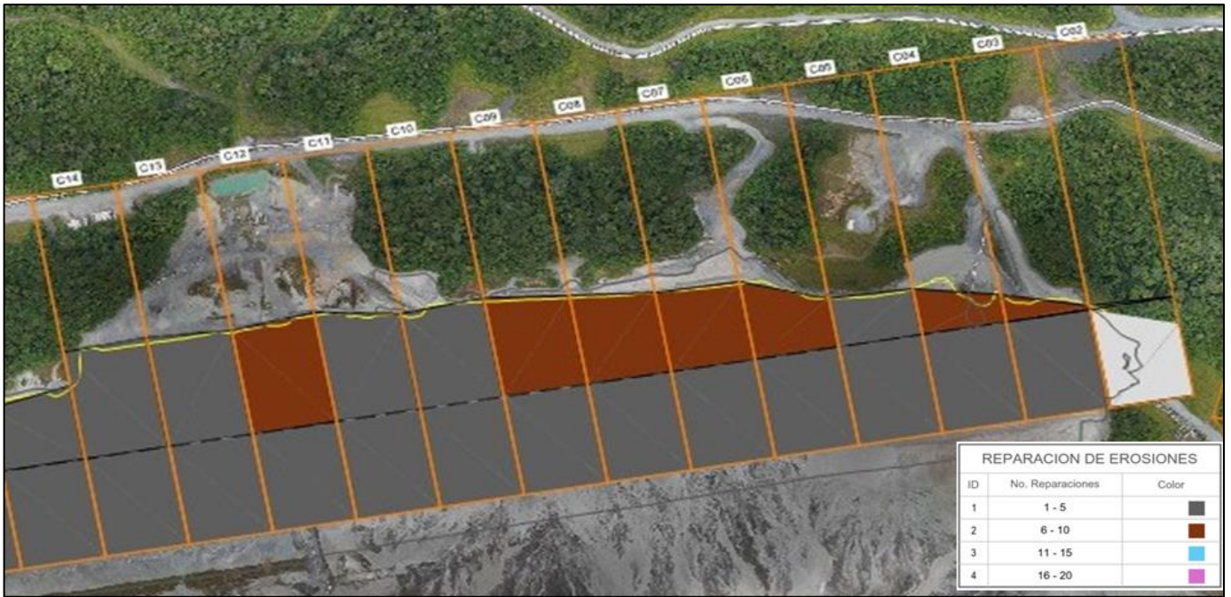
Figura 23 - Mapa de frecuencia de reparación de erosiones Muro Norte (Celdas 02 a 16)
