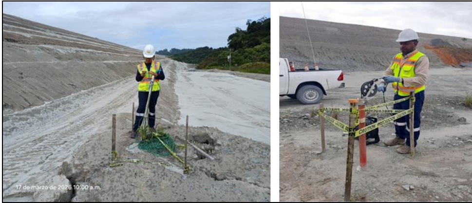
Figura 83 - Lectura de instrumentación geotécnica (Casagrande e inclinómetro)
