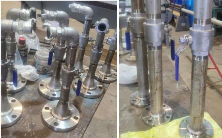
Fabricación de Sistema de venteo
