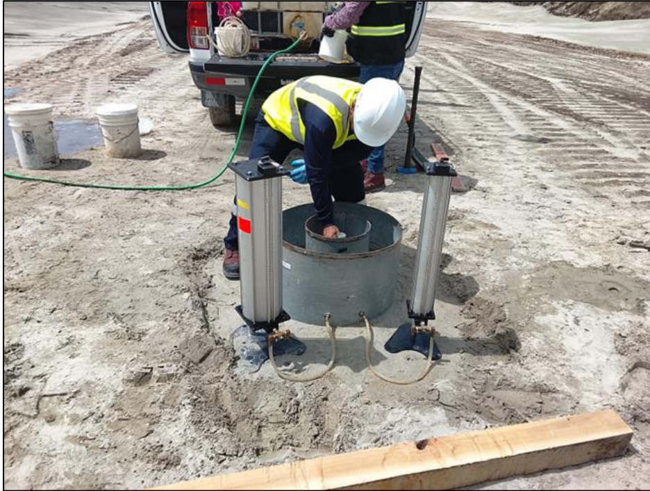
Figura 79 - Ensayo de Infiltración en Muro Este, Celda 33/34 Aguas abajo
