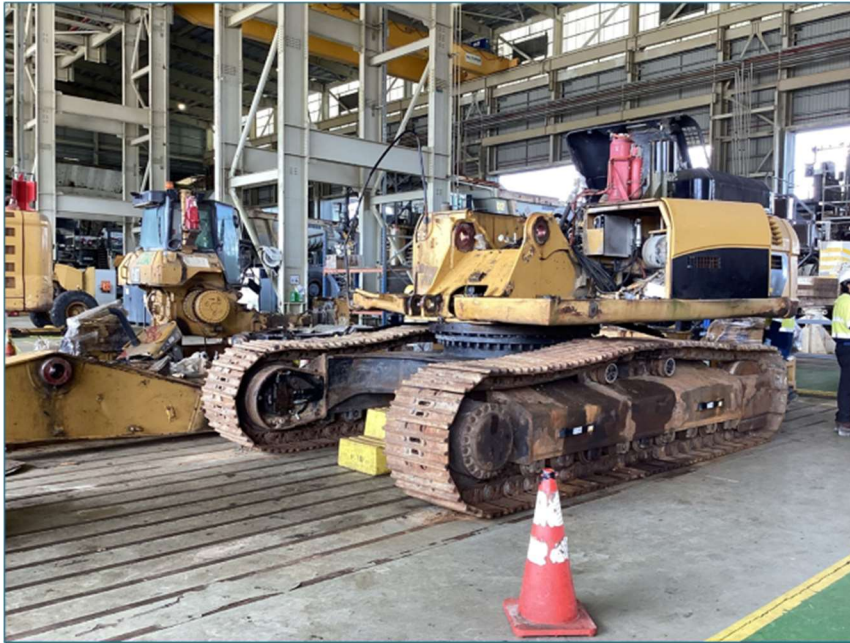
EX019. Reemplazo de líneas hidráulicas + montaje de cabina
