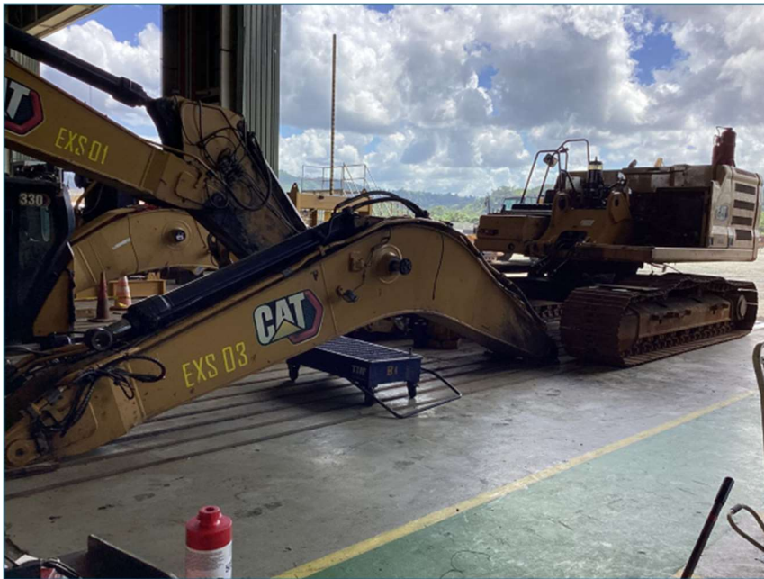
EX003. Desmontaje de cabina + limpieza de chasis
