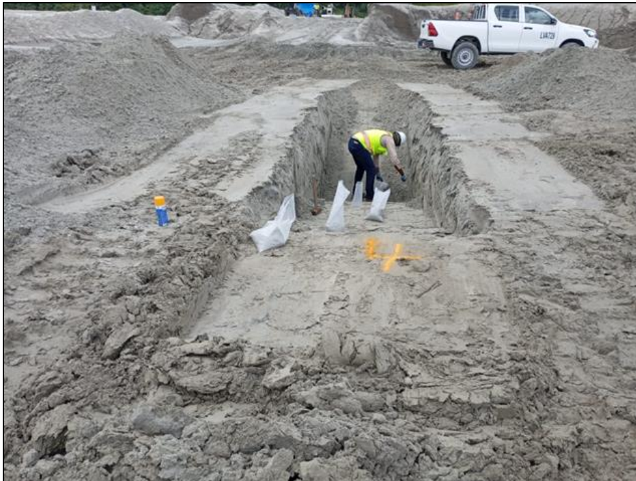
Figura 82 - Toma de muestra para monitoreo de % de finos, Muro Este, Celda 33/34 Aguas abajo
