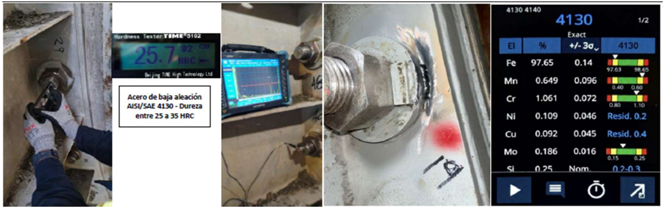
IMAGEN 1: Evaluación interna con ultrasonido por arreglo de fases en pernos del anillo rozante / Identificación positiva del material ensayo de dureza HRC / reparación de soldadura en arandela
