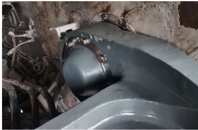
DTU031 Cambio de cilindro de suspensión frontal derecho
