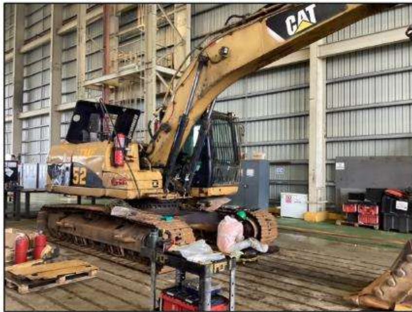
EX052 – PM + Backlogs + reparación de Balde
