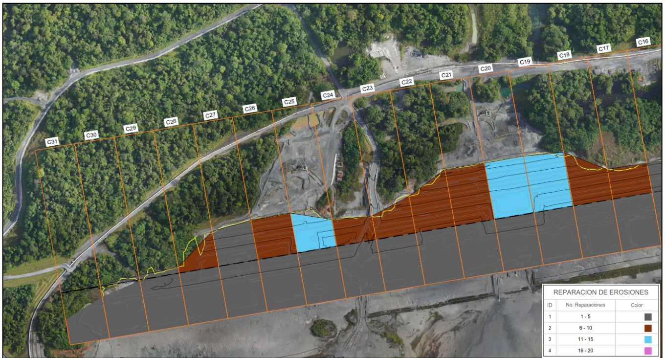
Figura 29 - Mapa de frecuencia de reparación de erosiones Muro Norte (Celdas 17 a 31)
