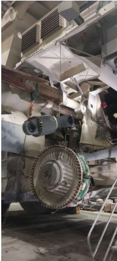
DTU031 Cambio de cilindro de suspensión frontal derecho
