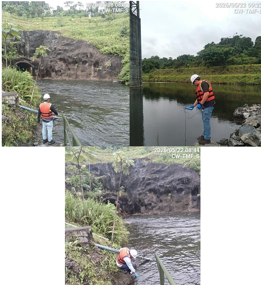
Fotografías 10. Toma de muestras en el túnel de descarga de la IMR
