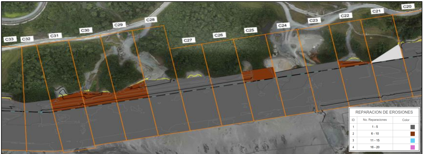
Figura 31 - Mapa de frecuencia de reparación de erosiones Muro Este (Celdas 32 a 21)
