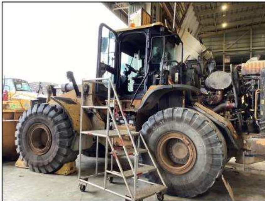
WLD003 – Reemplazo de Harness de Cabina + traslado a taller.
