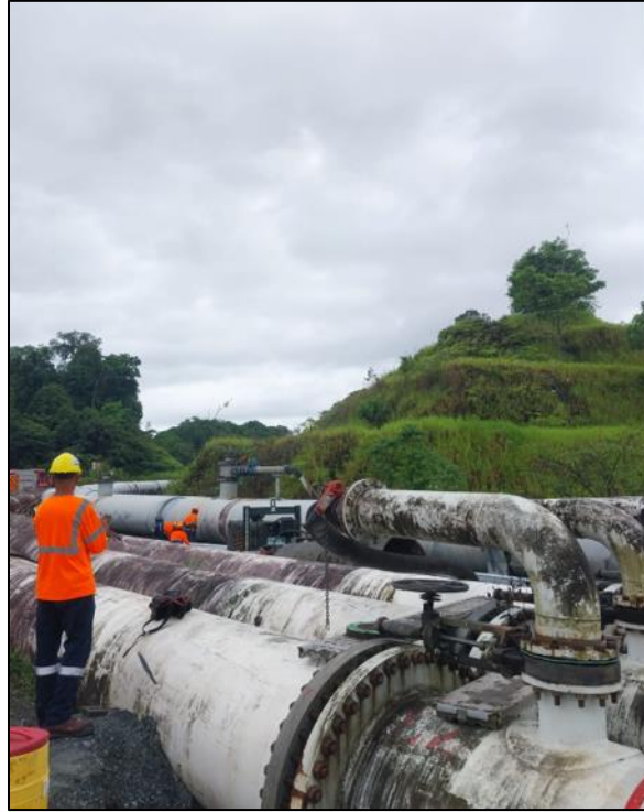
Figura 10 - Prueba de Hermeticidad en Línea R2 de Relaves
