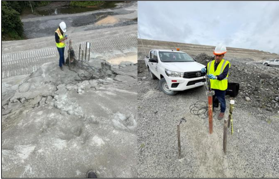
Figura 90 - Lectura de instrumentación geotécnica (Piezómetro e inclinómetro)
