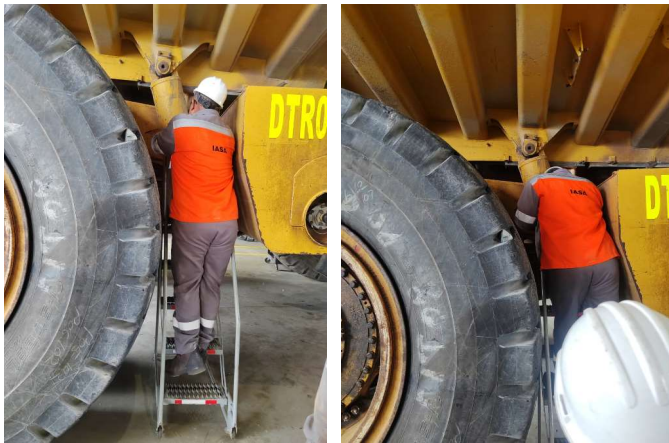
DTR013 Cambio de bearing cilindro levante derecho
