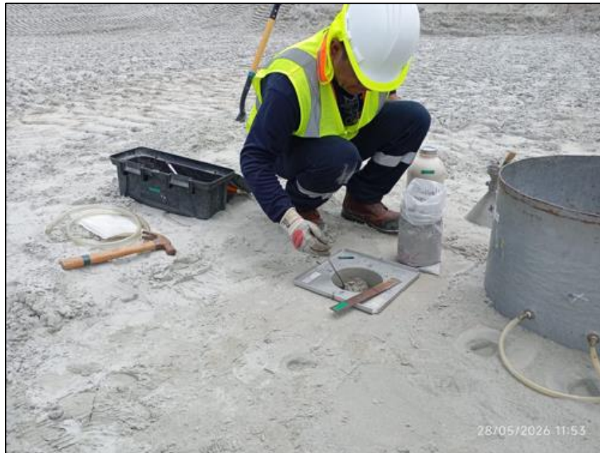
Figura 87 - Ensayo de compactación, método Cono de Arena, Muro Norte, Celda 28 Aguas abajo
