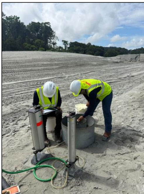
Figura 81 - Ensayo de Infiltración en Muro Norte, Celda 25 Aguas abajo
