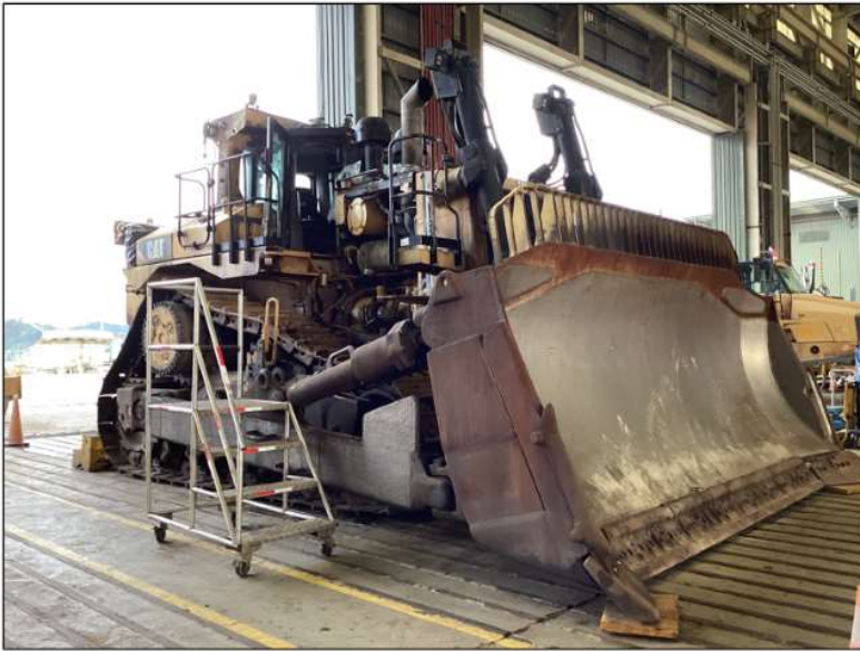
DZT103 - se inicio el recovery, en progreso para instalación de Blade
