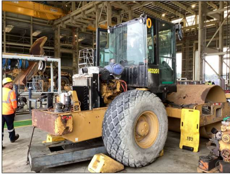
VCO201 - Reemplazo de motor
