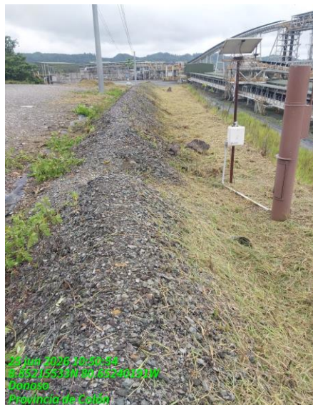
Fotografía 43. Limpieza de vegetación en Pluviómetro de Botija-Mina
