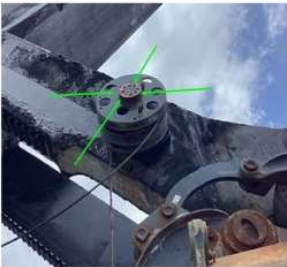
SHE-04 instalación de Guarda Trip Drum Balde
