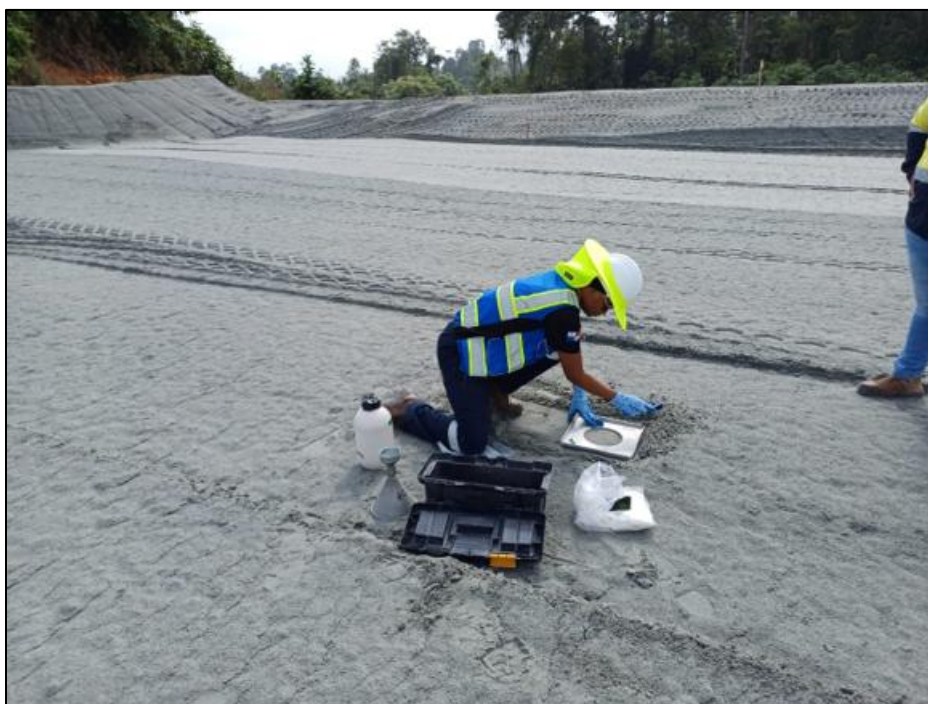
Figura 82 - Ensayo de compactación, método Cono de Arena, Muro Este, Celda 20 Aguas abajo
