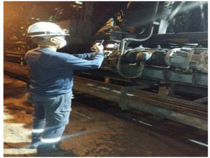
-Termografia de motores de TRIPPER TR02B
