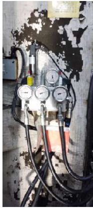
SHE-05 Corrección de fuga de aire de frenos de propel RH.
