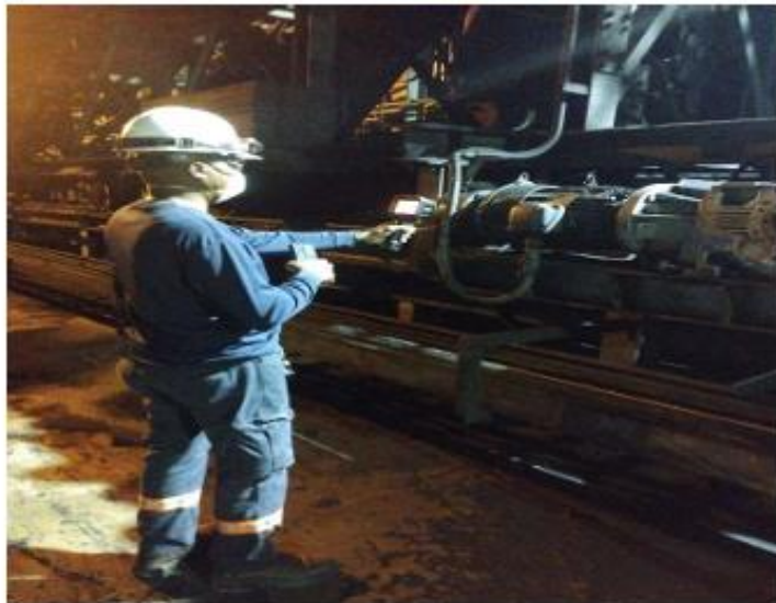
-Termografia de motores de TRIPPER TR02A
