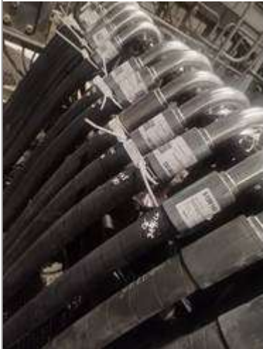
EXL-0000-107 Fuga hidráulica en conexión rotaria
