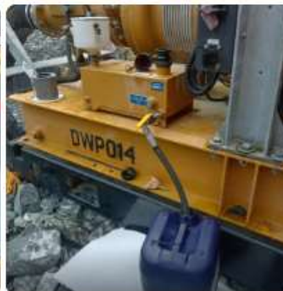
DWP014 Revisión de equipo y Reemplazo de mangueras Hyd
