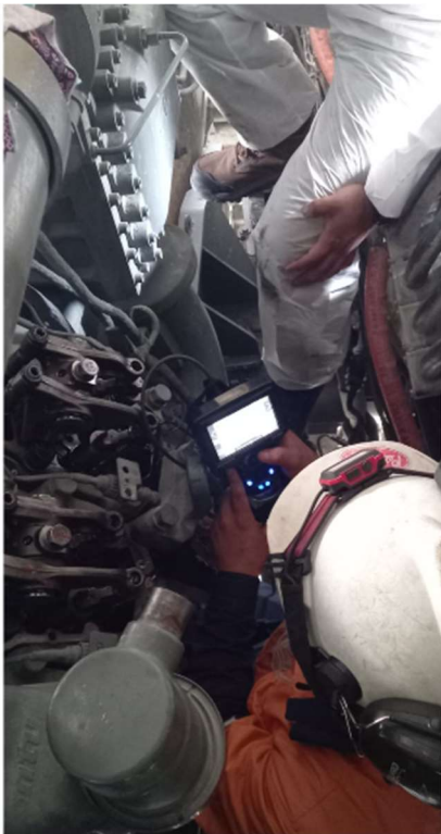
DTU006, Agua en el tanque de combustible ,cambio de inyectores
