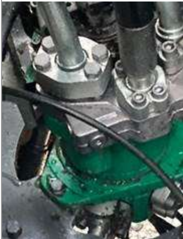
EXL-0000-107 Fuga hidráulica en conexión rotaria
