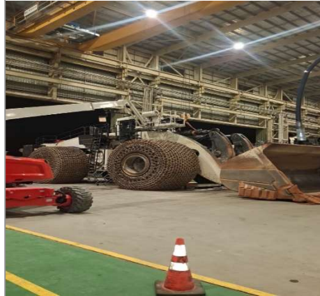
WLL001 Desmontaje del cilindro de volteo por cambio de bearing
