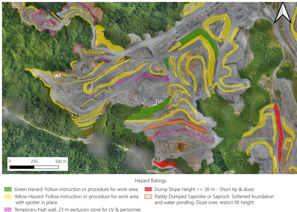
Figura 2. Actualización del Mapa de Riesgos del desarrollo del Tajo Colina. Se incluye la zona A3 por reporte de inestabilidad en banco de saprolita, en la Fase 1 de Colina.
