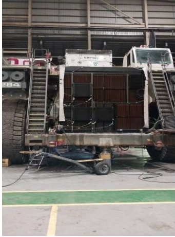
DTU015. Cambio de motor Diesel
