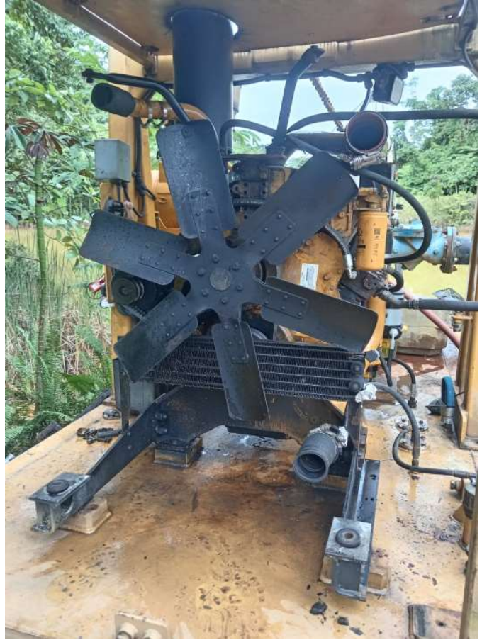
Reemplazo de radiador por fuga DWP003 1
